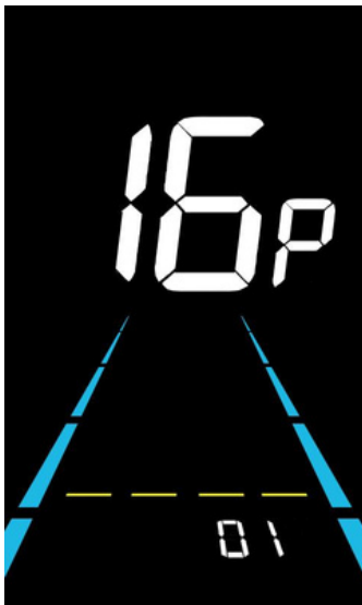
Obrázok 6-16 ODO resetuje rozhranie nastavenia
