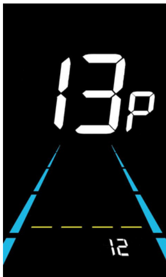
Obrázok 6-13 Rozhranie nastavenia počtu magnetov snímača asistencie pedálov
