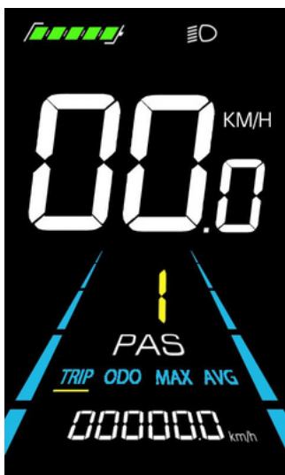
Figure 5-3 B rozhranie displeja s podsvietením
