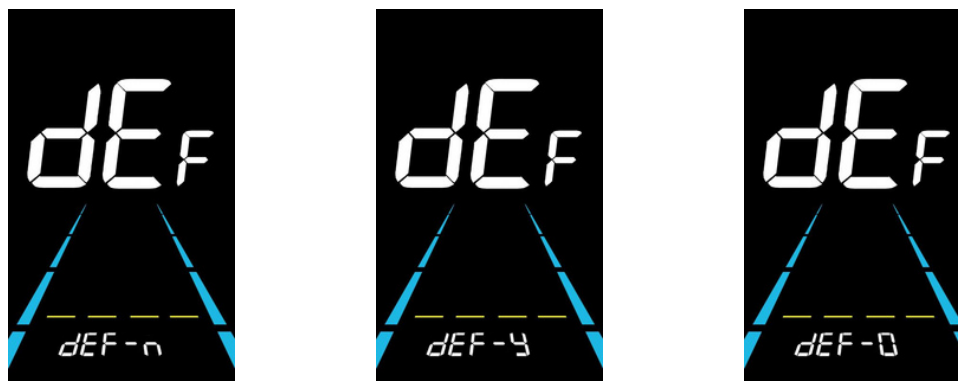
Obrázok 7-1 Rozhranie obnovenia predvolených nastavení z výroby
